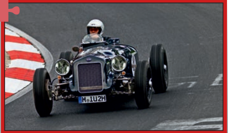
TYP: Delage SS Special, 2664 ccm, 160 PS BAUJAHR: 1938 Reinhard, Pütz DEU
